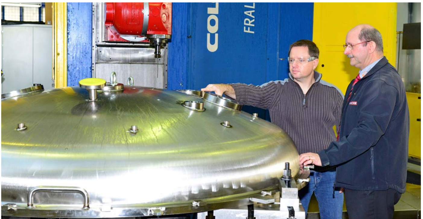
Gerade für Anlagen im Lebensmittelbereich werden oft schwer bearbeitbare Hochleistungsstähle verwendet. Für Ferrum AG und das Team von Daniel Frey, kein Problem: «Wir gehören auch mit zu den ersten, die iMachining einsetzen.» Im Hintergrund die Colgar Grossbearbeitungsmaschine mit 10 Achsen.
